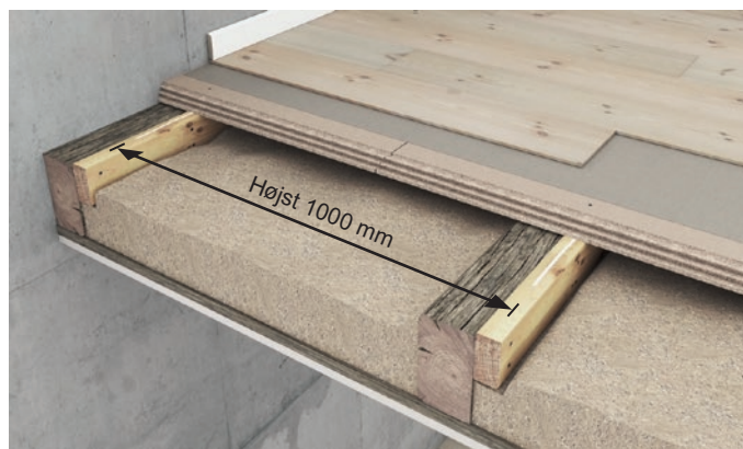
Figur 2 Ældre etagedæk oprettet med planker. Ved store spænd kan der monteres planker på begge sider af gulvbjælkerne for at reducere spændvidden.
